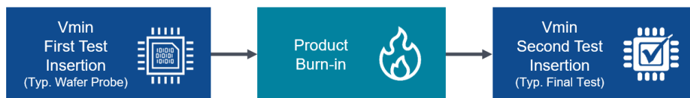
图 3: 老化测试的衡量标准: V_{min} 退化。
